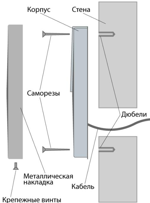
Рисунок 2. Крепление считывателя PNR-P15
