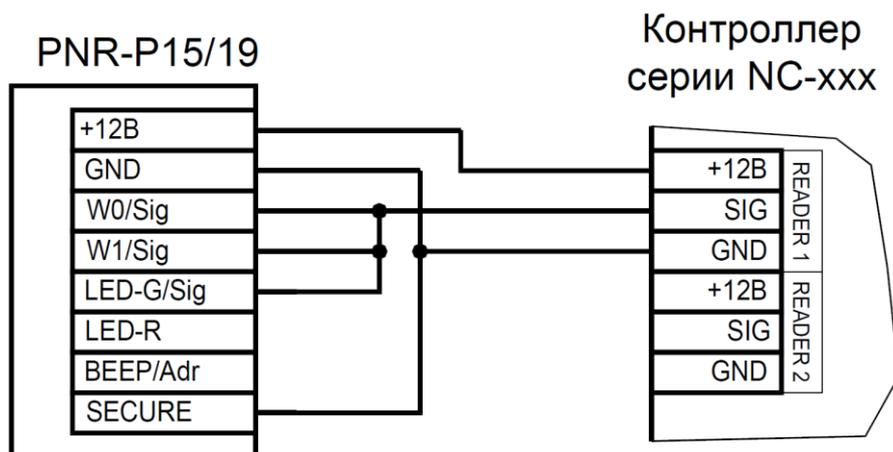
Рисунок 11. Аппаратное включение режима «Защищенный Parsec» на примере считывателя, подключенного по интерфейсу Parsec
