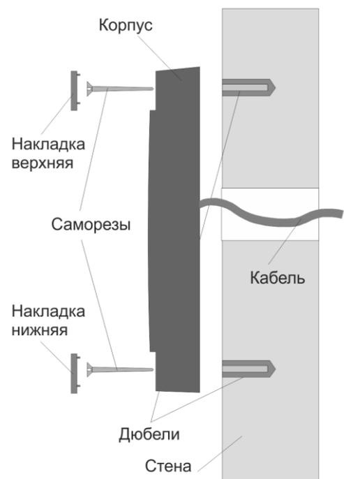
Рисунок 4. Крепление считывателя PNR-P19
