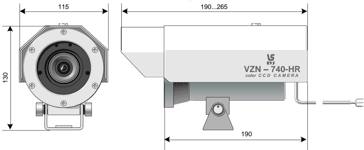
Рис.2. Камера **VZN-740-HR** в металлическом корпусе
