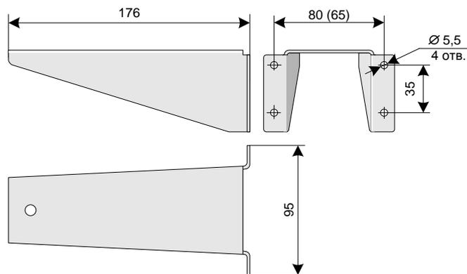
Рис.3. Кронштейн для крепления камеры в металлическом корпусе.
