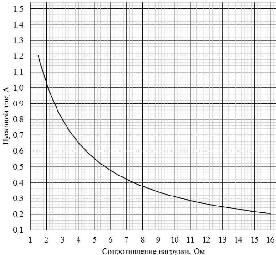
Рисунок 1 – График зависимости пускового тока от сопротивления нагрузки
