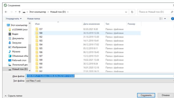
Импортируются (и экспортируются) все настройки камеры, за исключением сетевых настроек и настроек пользователей. Настройки экспортируются в виде файла с расширением coi. Импортировать сохраненные настройки можно только на устройство с аналогичной аппаратной версией и аналогичной версией прошивки.
