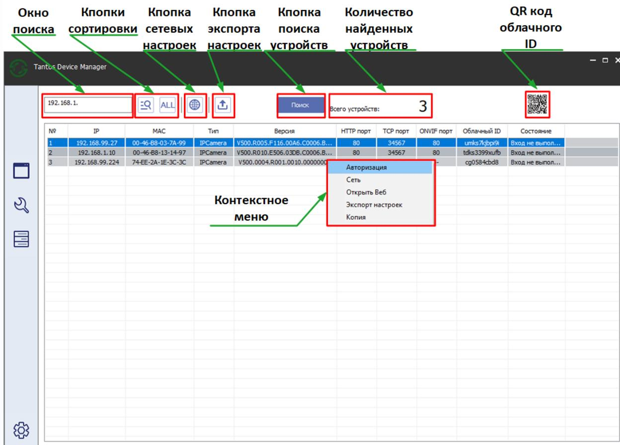
Кнопка предназначена для поиска устройств.
