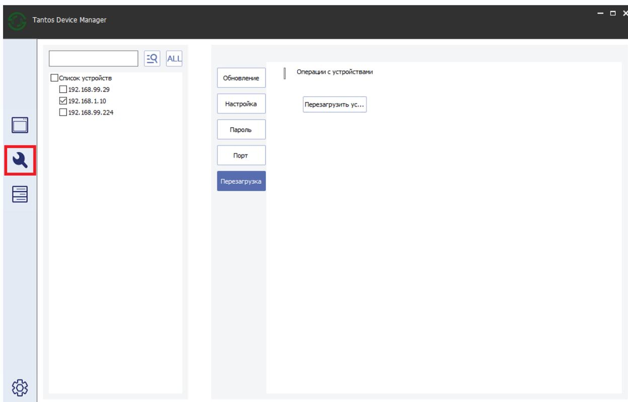
В данном окне можно обновить прошивку устройств, импортировать настройки, изменить пароль, изменить порты и перезагрузить устройства.
