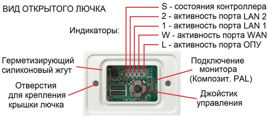
Рис. 5.3.1 Внешний вид ОПУ и назначение элементов конструкции, вид служебного лючка и назначение его компонентов
