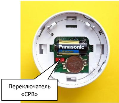
Поднесите извещатель к прибору. Двойным нажатием на тестовую кнопку извещателя инициируйте передачу посылки на прибор. Прибор, получив эту посылку, обрабатывает её и выдаёт результат:
