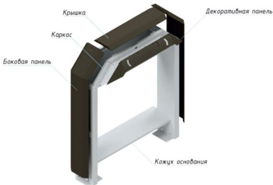
Рисунок 6.1.2. – Элементы корпуса турникета ЛКД ТТ-22-10
