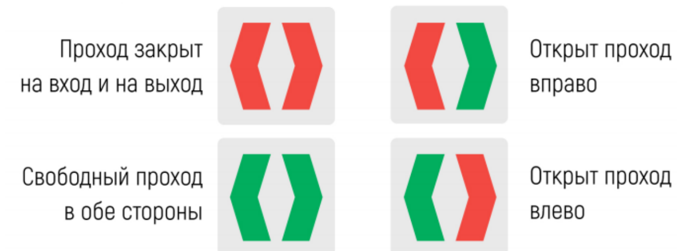
Рисунок 8 – Режимы индикации турникета
