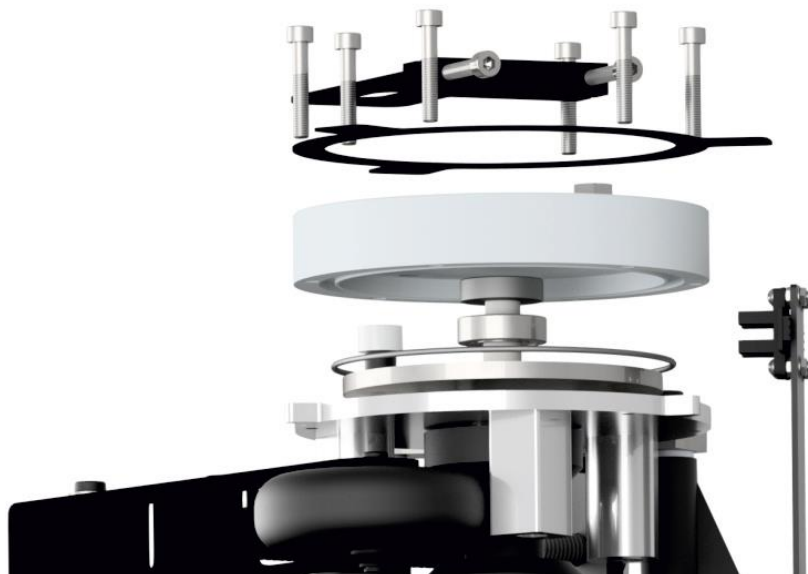
Рисунок 12.3.2 – Порядок замены сальника
