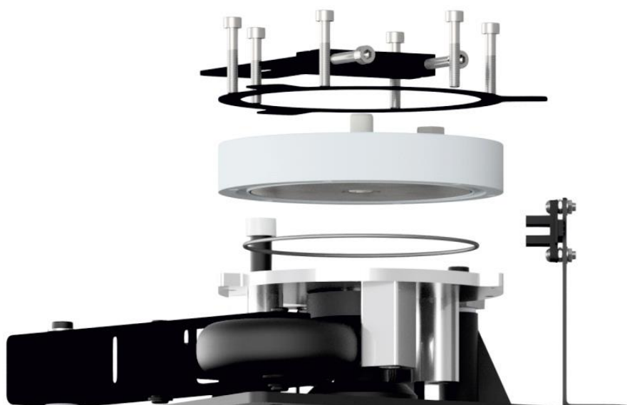
Рисунок 12.3.1 – Порядок замены уплотнительного кольца
